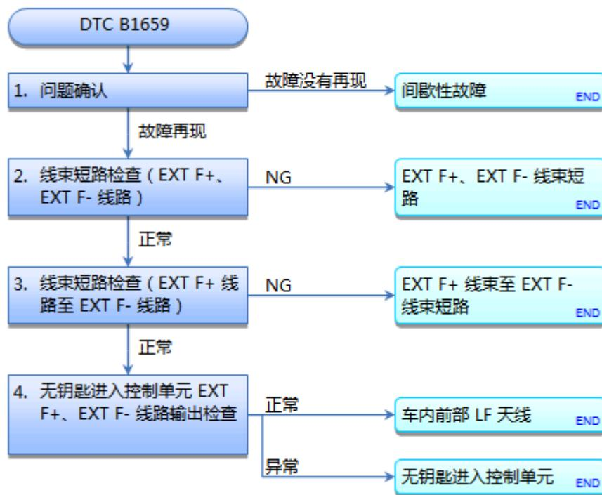
**DTC B1659: 车内前部 LF 天线电路短路**
